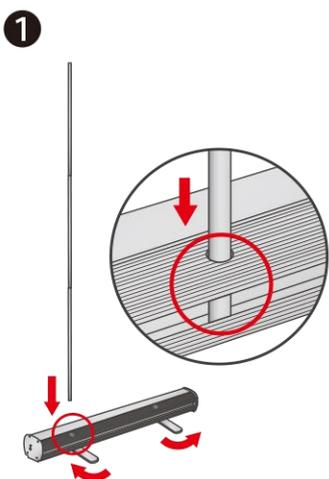
本体の脚を90度回転させ開き、支柱を本体の差込穴に差し込みます。
