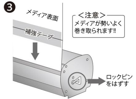
メディアの取り付けが完了してから、ロックピンを外し、ゆっくりメディアを収納します。
