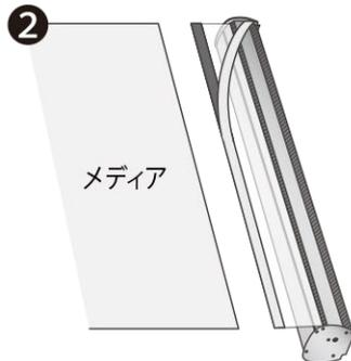
取付けシートを引っ張り出し、メディア裏面へ両面テープで貼り付けます。また、透明補強テープを表側に貼ります。
