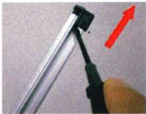
① 上部バー両端キャップをドライバーで外す。
